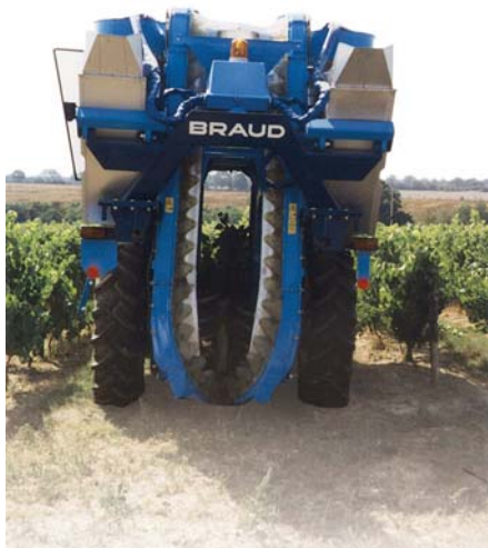
Vibracijske palice iz Ertalona 66 SA na strojih za pobiranje grozdja (pod sliko traktorja)
